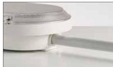
Possibilità di entrata con passacavo dal retro, oppure lateralmente con tubo rigido da 16 mm. o 20 mm. mediante il **raccordo rapido predisposto** sull'apparecchio che permette il mantenimento dell'IP65 **anche senza l'utilizzo di un raccordo stagno tubo-scatoia**.
